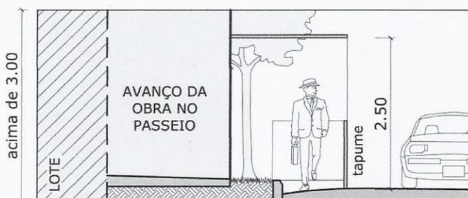
Figura 02 – Desvio de circulação de pedestres em decorrência de avanços de obras na calçada – corte esquemático.
